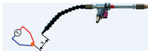
Фиг. 7. . Принципна схема на разположението на измервателната система при A=15 и 30\text{mm}
