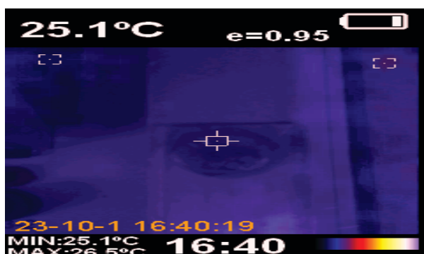
Фиг. 6. Термовизионно изображение на едноболтово съединение Al шина
