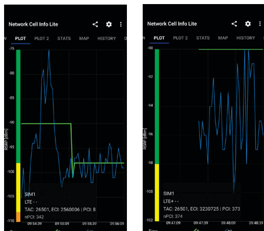
Фиг. 5. Отчитане на силата на сигнала S и нивата на съседна клетка N
