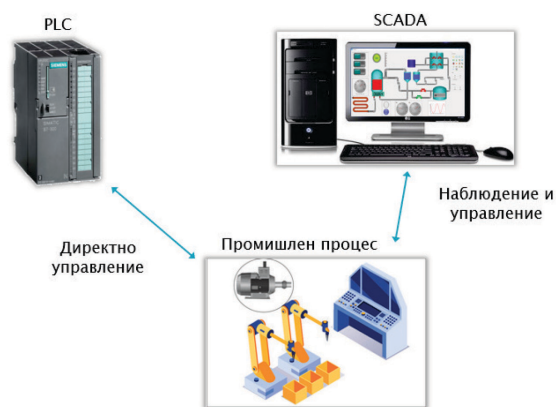
Фиг. 1. Компоненти за управление на производствен процес
